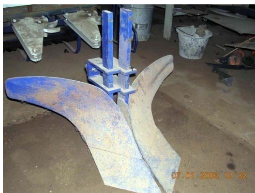
Gambar 2.26a. Furrower yang dirancang untuk ditarik traktor roda dua (Lab. Mesin Budidaya, Departemen Teknik Pertanian, IPB)
