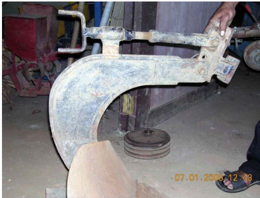
Gambar 2.26b. Mekanisme pengatur kedalaman alur untuk membuat alur miring
