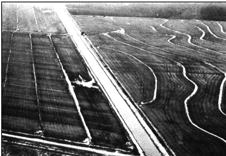
Gambar 2.12. Irigasi basin padi sawah, sebelah kiri sesudah konsolidasi lahan, sebelah kanan tanpa konsolidasi lahan
