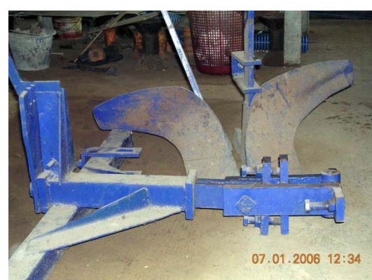
Gambar 2.26a. Furrower yang dirancang untuk ditarik traktor roda dua (Lab. Mesin Budidaya, Departemen Teknik Pertanian, IPB)
