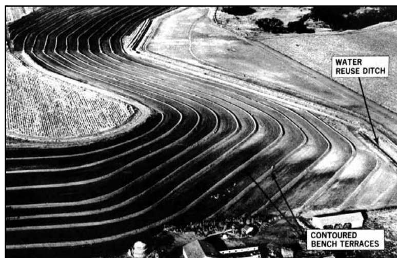
Gambar 2.1c. Border pada lahan miring disebut juga sebagai teras bangku berlereng untuk tanaman non-padi
